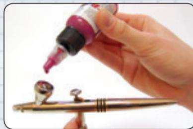
Es sind alle gängigen Airbrush-Farben oder Lacke geeignet, die eine milchähnliche Konsistenz haben. Die Farbe ist ggf. entsprechend zu verdünnen. Die Geräte der Evolution Silverline-Serie sind speziell für die Verwendung von lösemittelhaltigen Produkten konstruiert.
